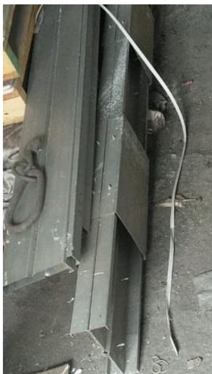
Рис. 3.2 В процессе огневых испытаний балка «развернулась» относительно своего первоначального состояния и обрушилась
