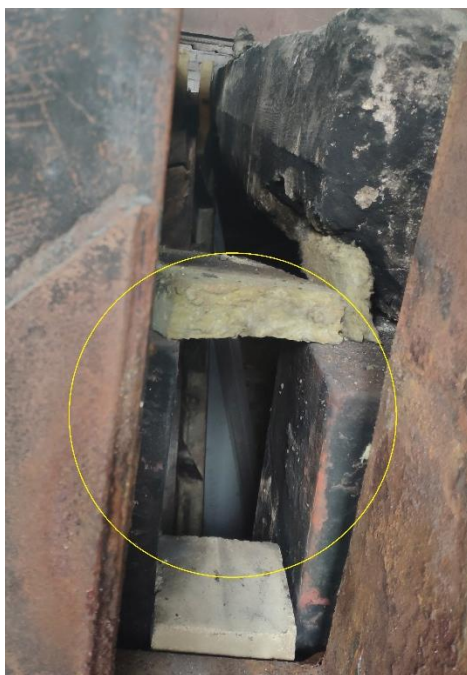
Рис. 3.2 В процессе огневых испытаний балка «развернулась» относительно своего первоначального состояния и обрушилась
