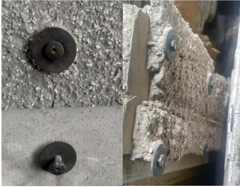
Рис. 3.10 Способы креплений внешних обшивок самонарезными винтами с шайбами, обшивной материал не отвалился в зоне таких креплений в процессе испытаний
