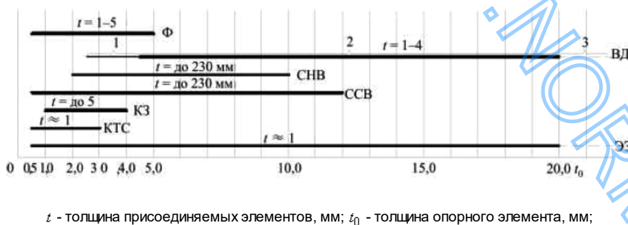
Ф - фальцовка; ВД - дюбель высокопрочный (1, 2 и 3 - "легкий", обыкновенного качества и высшего качества соответственно); ССВ - самосверляющий винт; СНВ - самонарезающий винт; КЗ - комбинированная заклепка; КТС - контактная точечная сварка; ЭЗ - электрозаклепки
