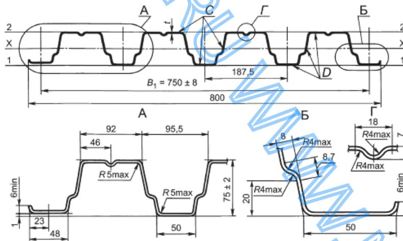
Рисунок Б.2 - Профили типа Н высотой 75 мм
