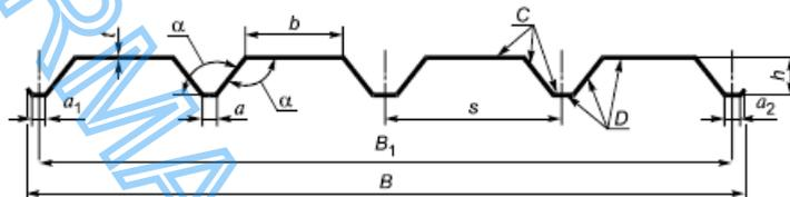
$B_1$  - монтажная ширина профиля;  $B$  - общая ширина;  $h$  - высота профиля;  $t$  - толщина профиля;  $s$  - шаг гофров;  $a$  и  $b$  - ширина полки профиля (в ряде случаев  $a=b$ );  $a_1$  и  $a_2$  - ширина крайних полки гофров профиля;  $C$  - наружная (лицевая) сторона профиля;  $D$  - обратная сторона профиля
