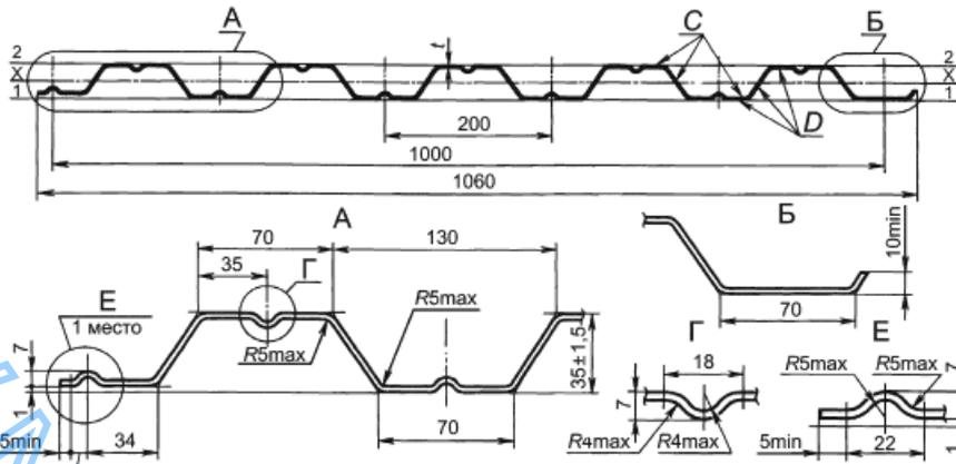
Рисунок Б.6 - Профили типа НС высотой 35 мм
