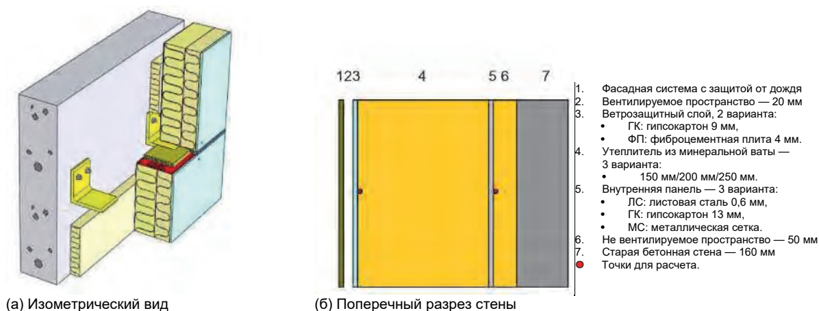
Рис. 3.4. Поперечный разрез анализируемой фасадной системы
