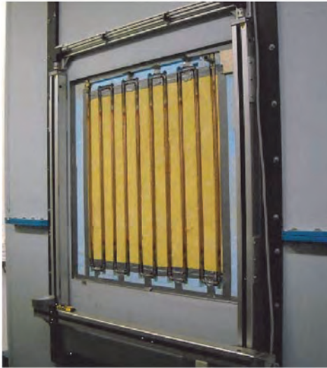
Рис. 6.17. Трубки для циркуляции воды, уложенные поверх теплоизоляции
