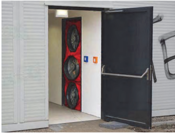
Рис. 4.22. Испытание на воздухопроницаемость с использованием трех вентиляторов (слева), результат (справа)
