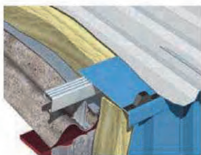
Установка новой крыши поверх старой и новой фасадной системы поверх старой из листового асбеста, сборная система
