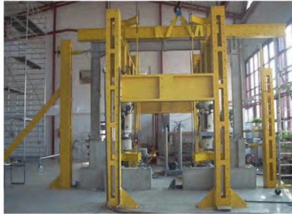
Рис. 5.15. Устройство рамы испытательной установки
