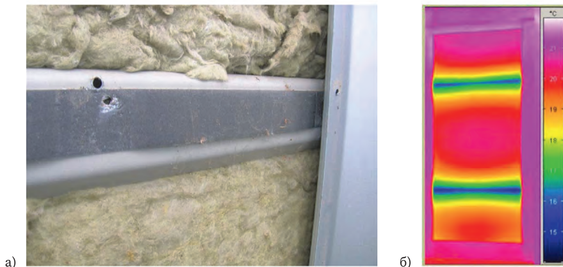
Рис. 4.5. Существующая кассетная стена (а), термограмма кассетной стены, полученная во время испытаний в горячей камере (б)
