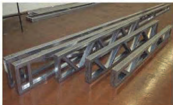
Части каркаса модуля крыши
