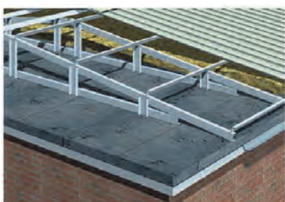
Трансформация плоской крыши в скатную с помощью легких стальных конструкций
