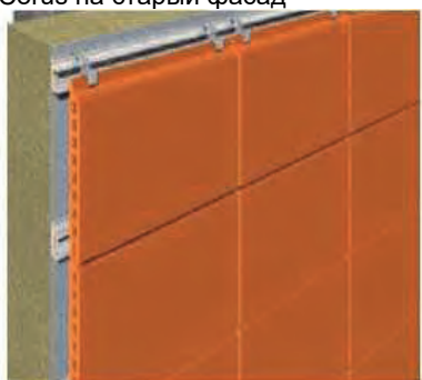
Установка композитных панелей с минеральной ватой
