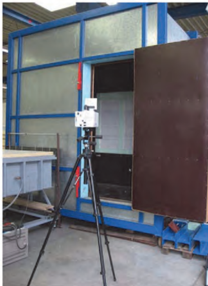
Рис. 4.7. Горячая камера с тепловизором (слева), результат установки фасадной системы на кассетную стену с заменой старого фасада (справа)
