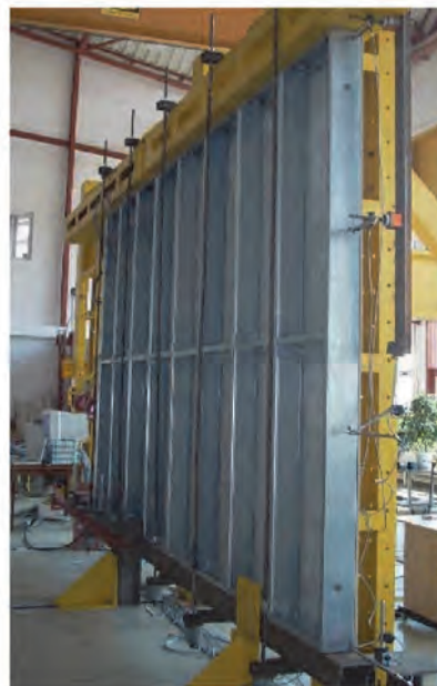
Рис. 5.19. Устройство сборной стены и стеновая панель до проведения испытаний
