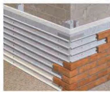
Облицовка из кирпича с использованием ячеистого теплоизоляционного материала, листовой стяжки и дополнительного каркаса
