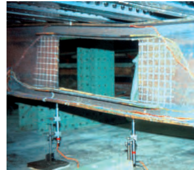
Рис. 1.5 Испытание комбинированной балки на изгиб по Виренделю
