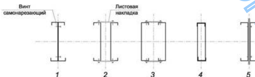
Рисунок А.1 - Одноточные сечения стоек каркаса КОС
