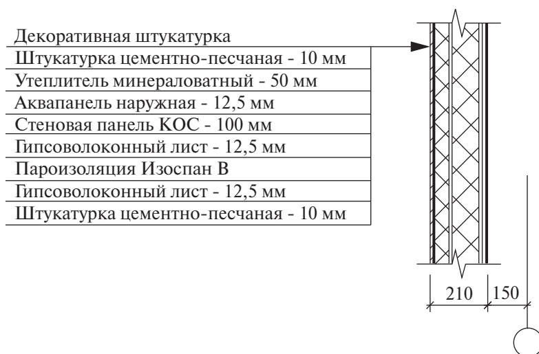
Рис. 2.1 Конструктивное решение наружной стены
