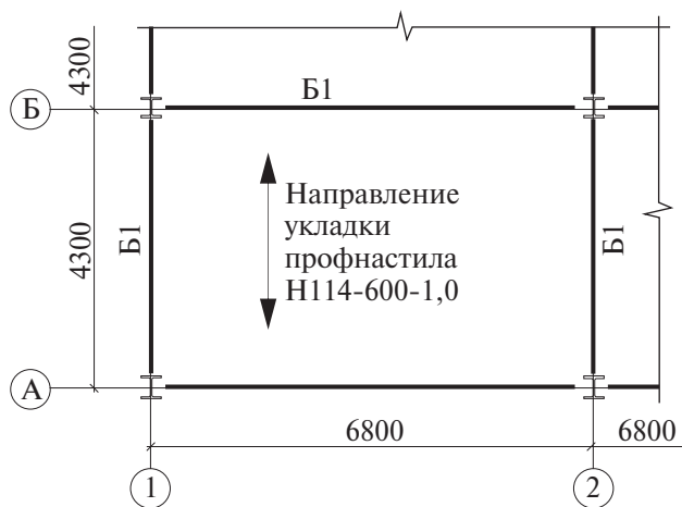
Рис. 2.4. Фрагмент схемы расположения балок и монолитного перекрытия
