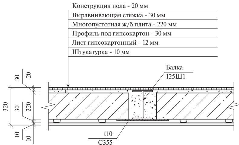
Рис. 1.6. Конструкция перекрытия
