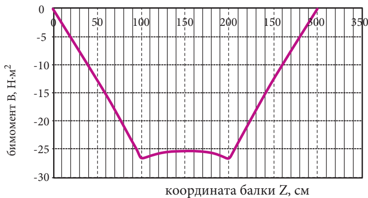
Рис. 8.2.22. Эпюра бимоментов в шарнирно опертой балке, нагруженной двумя сосредоточенными нагрузками с эксцентриситетом
