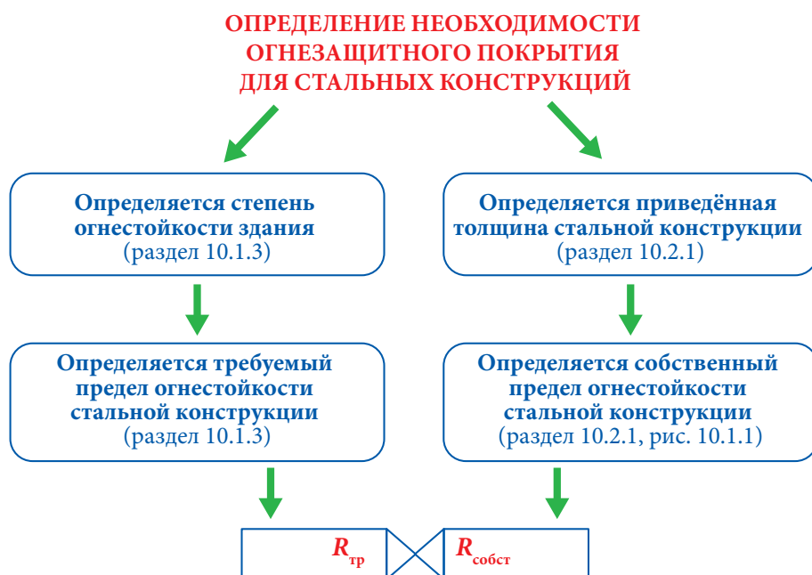
Рис. 10.2.5. Алгоритм определения необходимости огнезащитного покрытия для стальных конструкций
