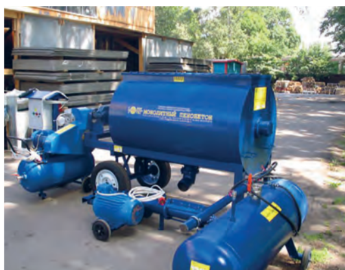
Рис. 8.4.2. Гироторная установка по производству монолитного пенобетона
