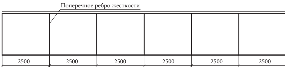
Рис. 3.6.8. Расположение ребер жесткости на балке
