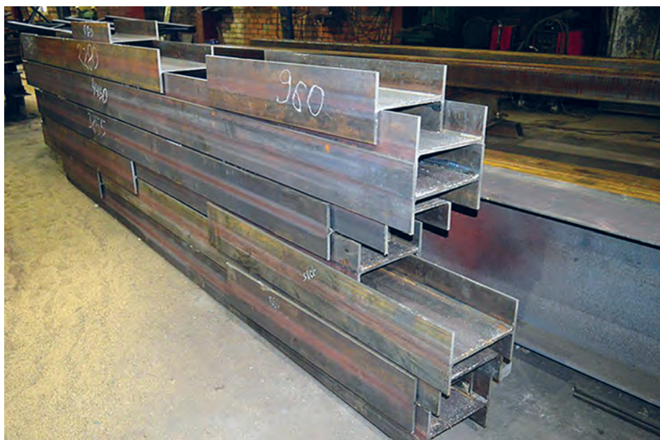
Рис. 1.6.4. Сварные двутавры с параллельными гранями полок из толстолистного проката
