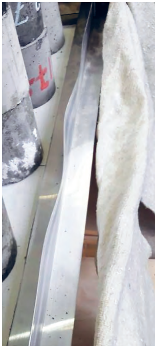
Рис. 8.3.19 а. Форма местной потери устойчивости сжатой стенки фрагмента таврового профиля (на изображении — полка ниже стенки)
