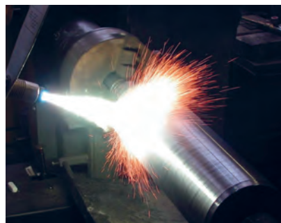
Рис. 10.4.3. Схема процесса газотермического напыления
