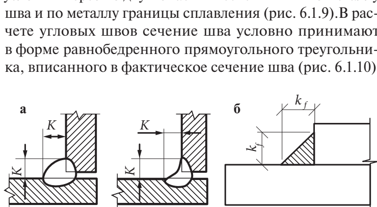
Рис. 6.1.10. Сечение углового шва: а) фактическое; б) расчетное
