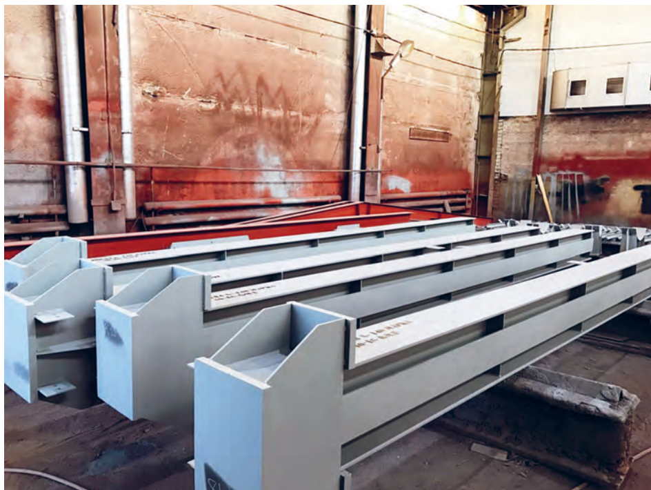
Рис. 1.6.3. Сварные строительные металлоконструкции коробчатого типа из толстолистного проката
