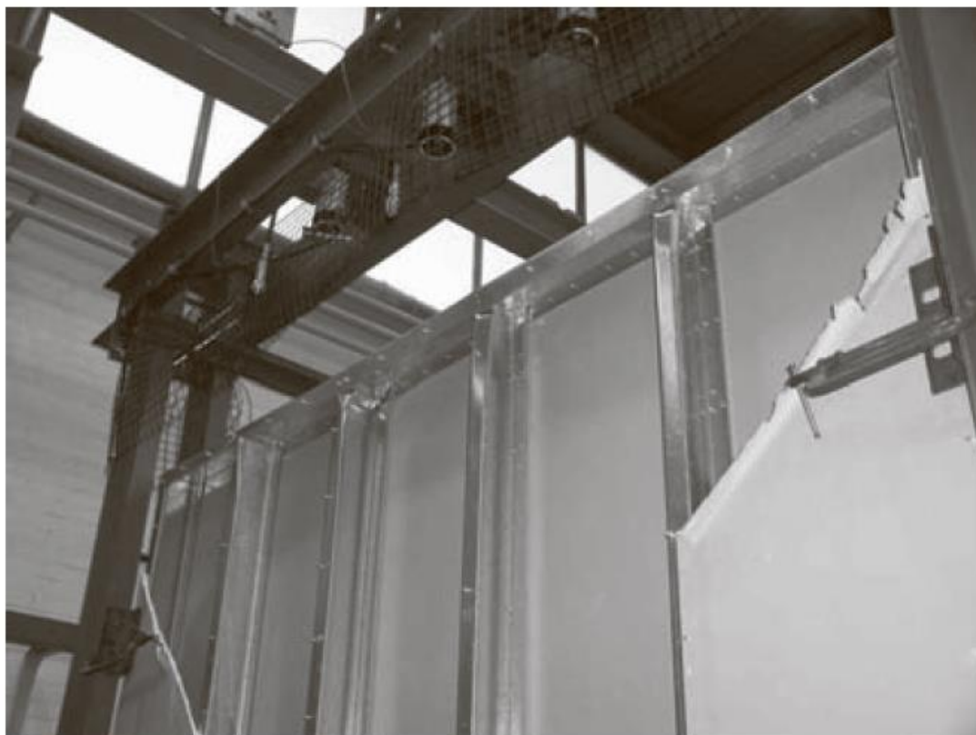
Рисунок 3-31. Окончательная форма стеновой конструкции Metsec после потери устойчивости
