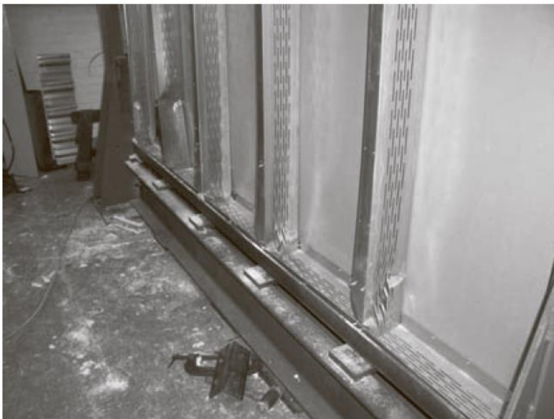
Рисунок 3-29. Окончательная форма стеновой конструкции Rannila после потери устойчивости
