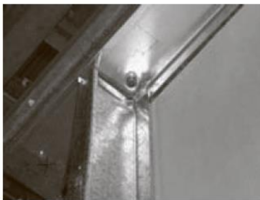
Вставка в направляющие — разрушение = 36,6 кН
