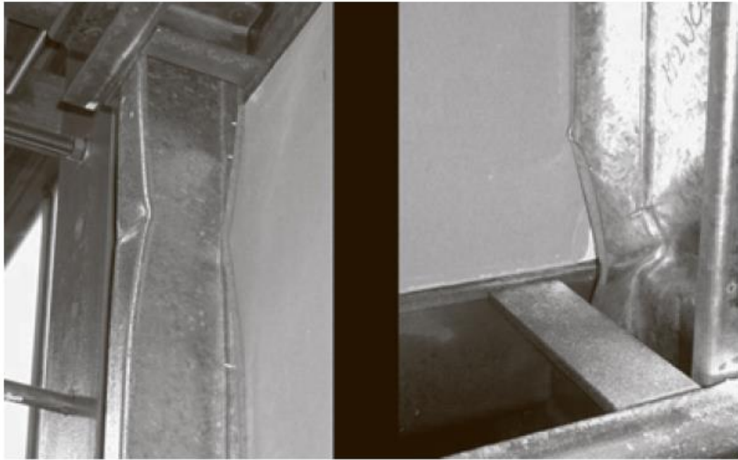
Рисунок 3-16. Сравнение режимов разрушения центрально и внецентренно нагруженных образцов среднего размера, имеющих закрепление с обеих сторон
