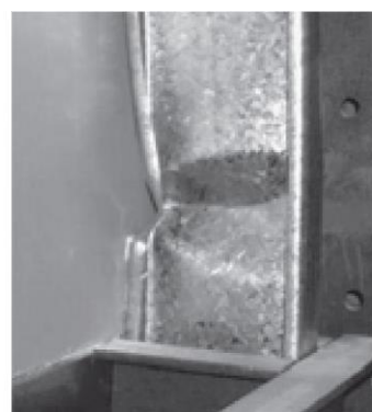
Разрушение образцов среднего размера = 57,4 кН
