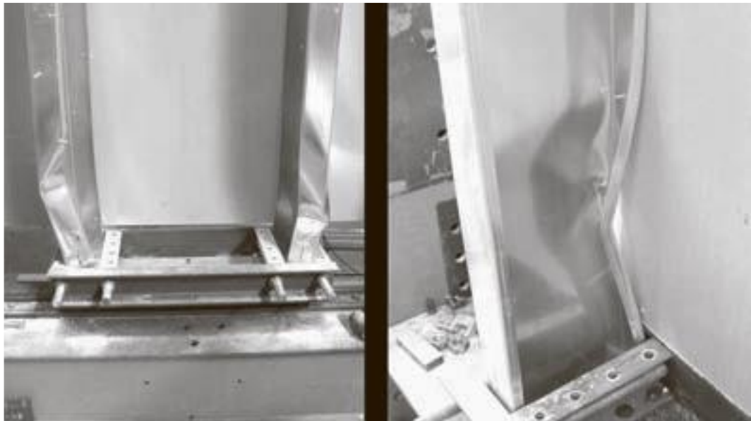
Рисунок 3-16. Сравнение режимов разрушения центрально и внецентренно нагруженных образцов среднего размера, имеющих закрепление с обеих сторон
