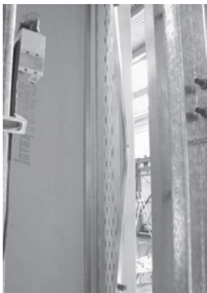
Рисунок 3-21. Модели разрушения профилей AWS для образцов, поддерживаемых только с одной стороны
