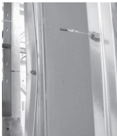
Разрушение профилей AWS = 43,2 кН
