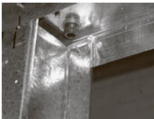
Крепление в направляющих — разрушение = 49,6 кН
