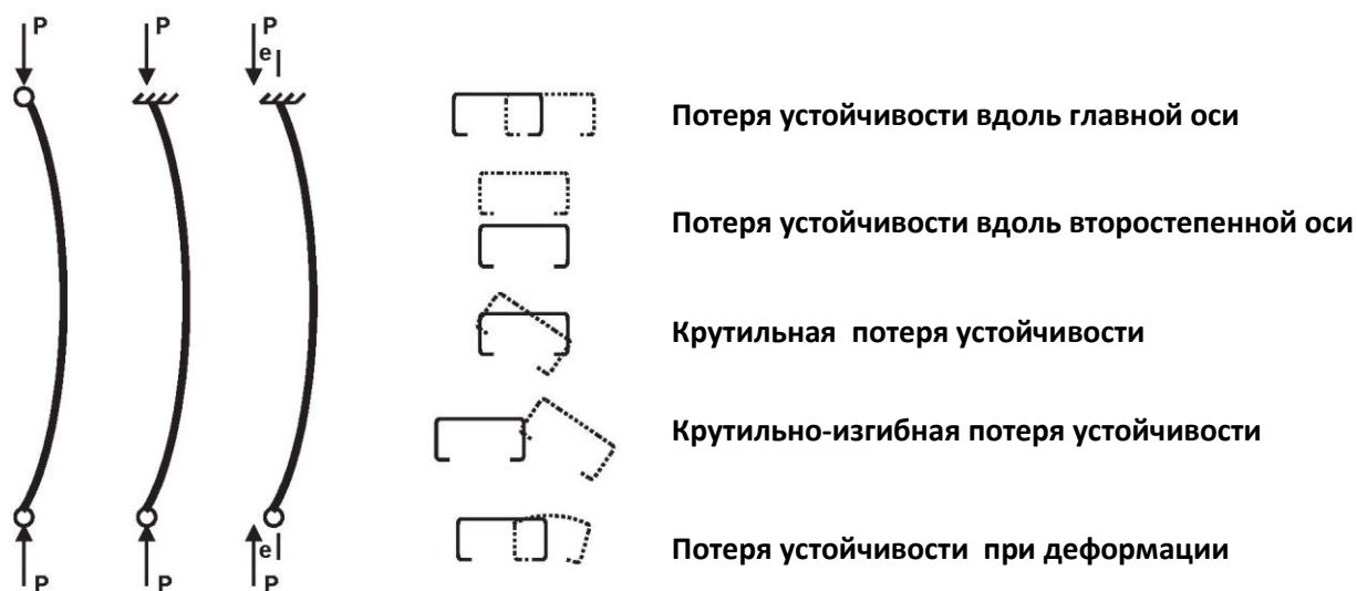
Рисунок 3-10. Основные режимы разрушения — общие
