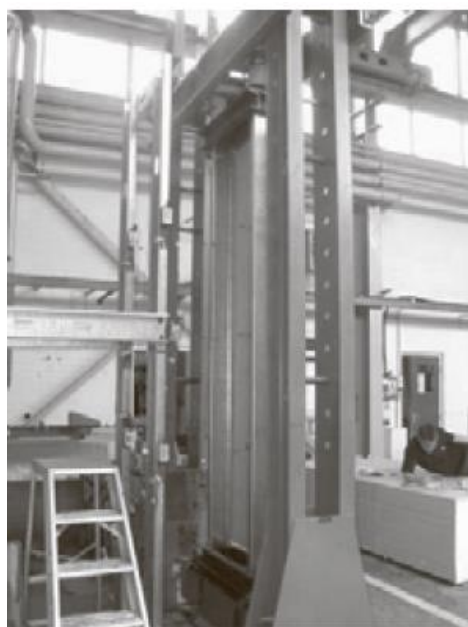
Рисунок 3-5. Внешний вид устройств измерения боковых смещений
