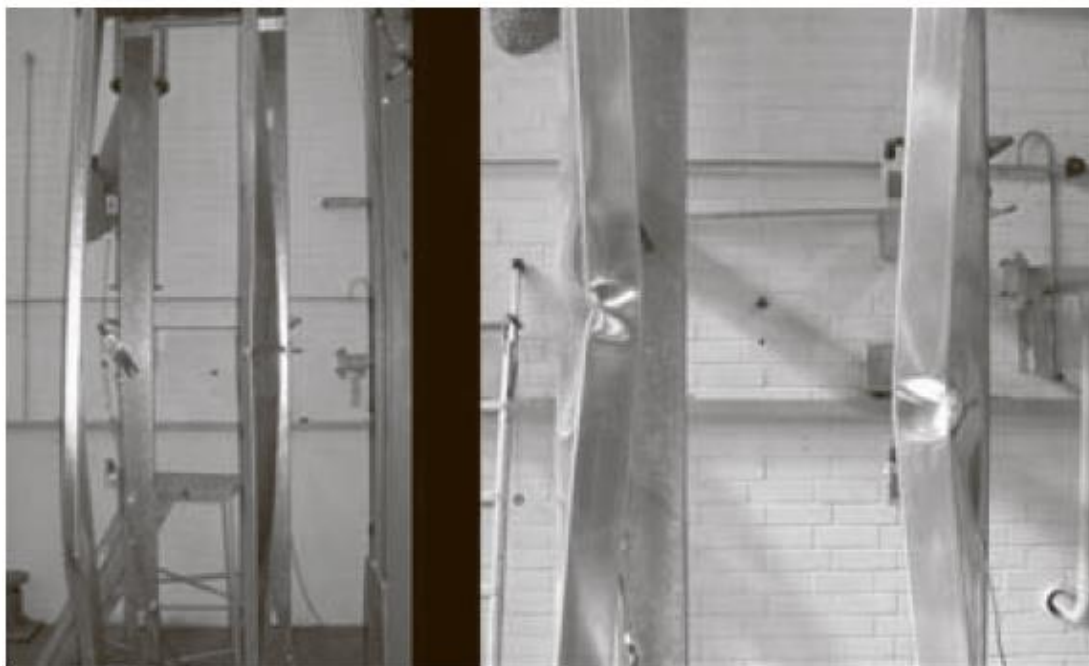
Профиль среднего размера — разрушение = 50,8 кН Профиль большого размера — разрушение = 177 кН
