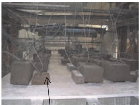
Нагружение перекрытия стальными блоками
