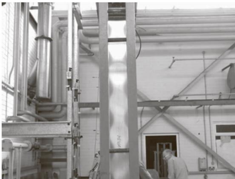
Рисунок 3-15. Стандартные местные потери устойчивости стенки образца
