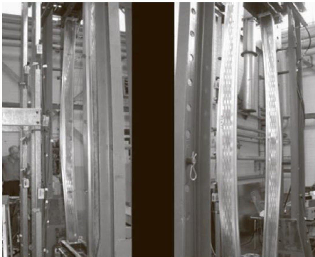
Рисунок 3-12. Сравнение результатов испытаний профилей AWS высоких стоек под воздействием нагрузки приложенной в центр сечения и нагрузки приложенной с эксцентриситетом
