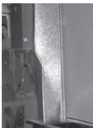
Разрушение образцов среднего размера = 44,9 кН
