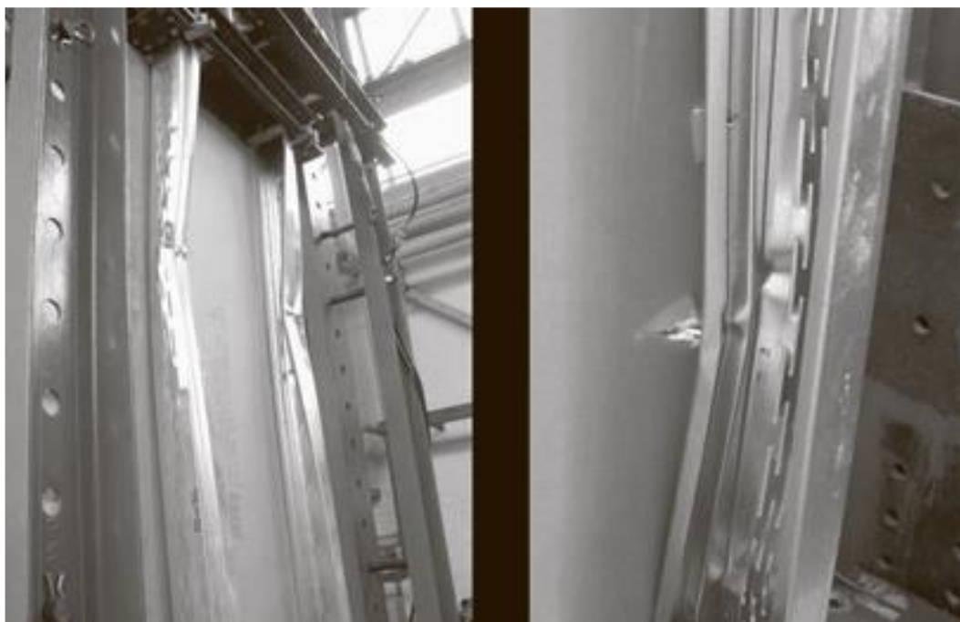
Рисунок 3-18. Сравнение режимов разрушения центрально и внецентренно нагруженных образцов AWS, имеющих опору с обеих сторон
