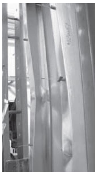
Разрушение образцов большого размера = 154 кН
