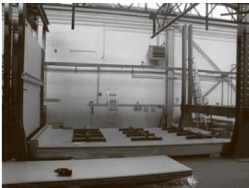
Рисунок 3-7. Детальный вид системы приложения нагрузки на конструкцию пола
